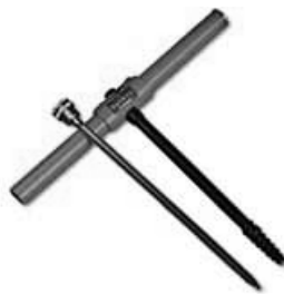
Figura 40 - Verruma ou trado, utilizada para obtenção de material para análise de anéis de crescimento.
