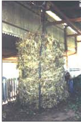
Figura 24 - Folhas retiradas das dornas após o processo de arraste do óleo essencial, denominado bagacinho.
