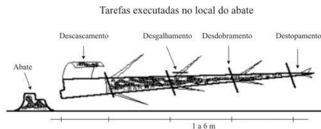
Figura 26 - Operações desenvolvidas com as árvores no sistema de colheita de toras curtas.
