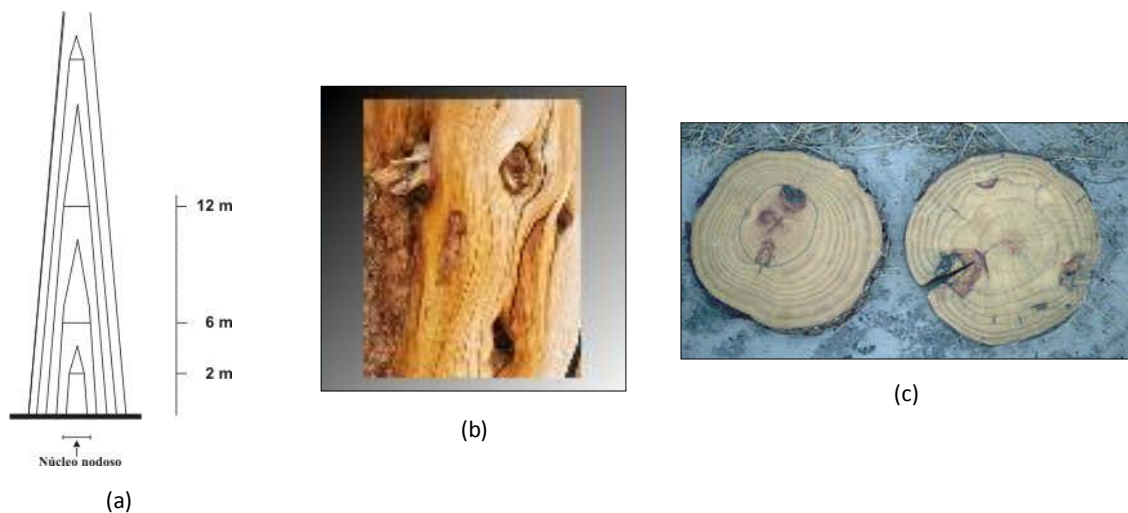
Figura 13 - (a) Simulação da definição do núcleo nodoso; (b) tronco descascado mostrando a formação de nós mortos; (c) discos de tronco desramado com núcleo nodoso (esquerda) e de tronco não desramado sem o núcleo (direita).
